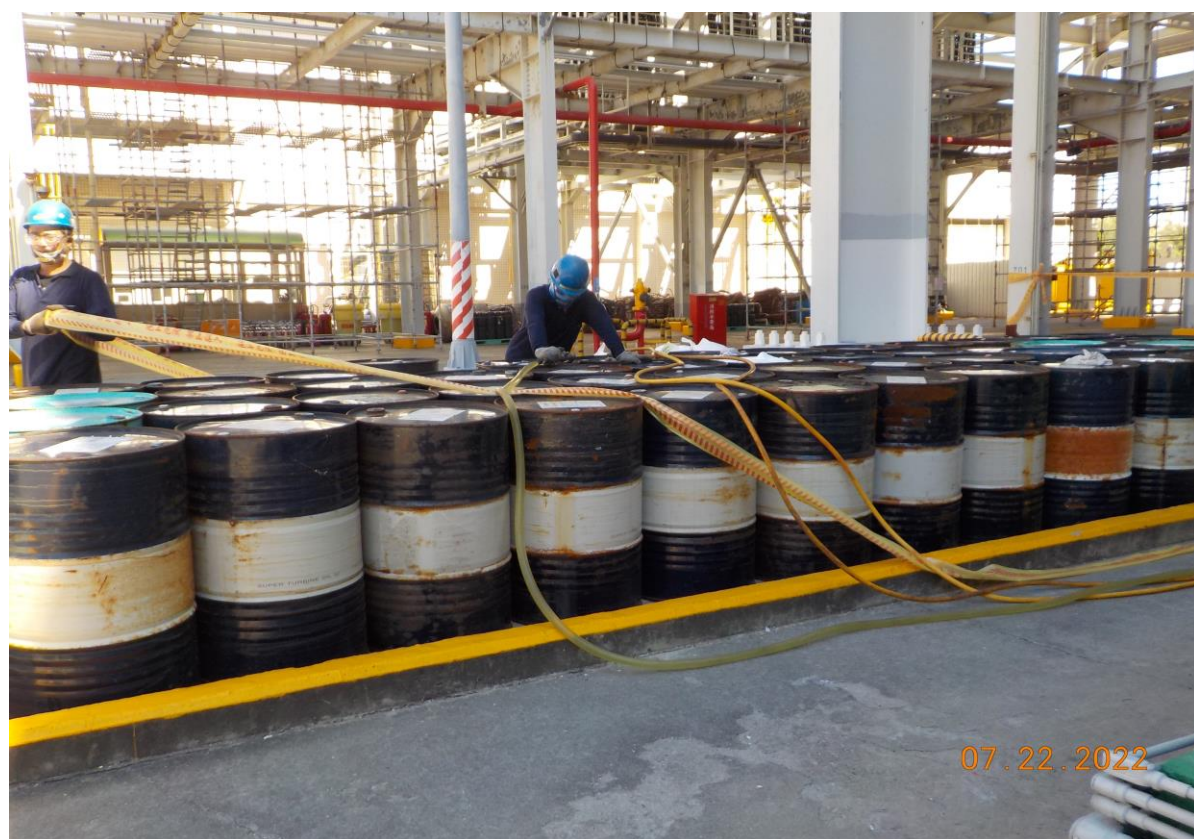
2.人員確認泵浦抽取廢油之情形
