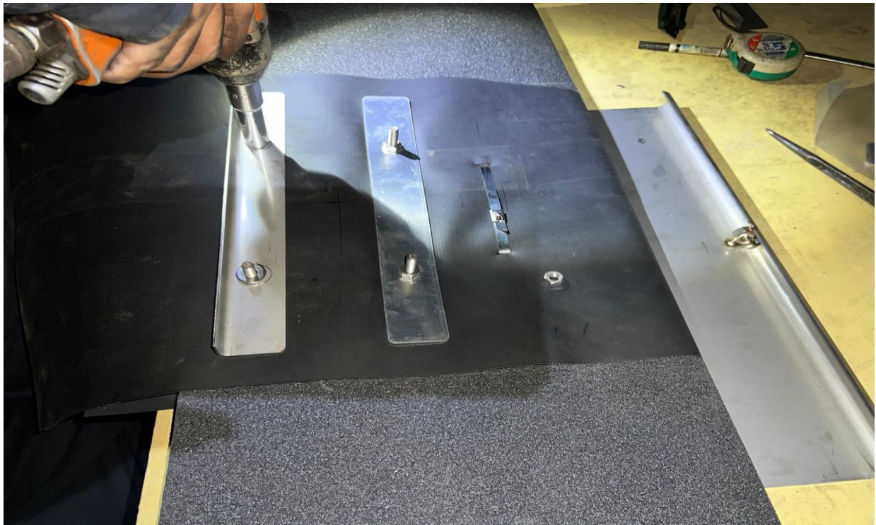
安裝二次刮板情況(13)
