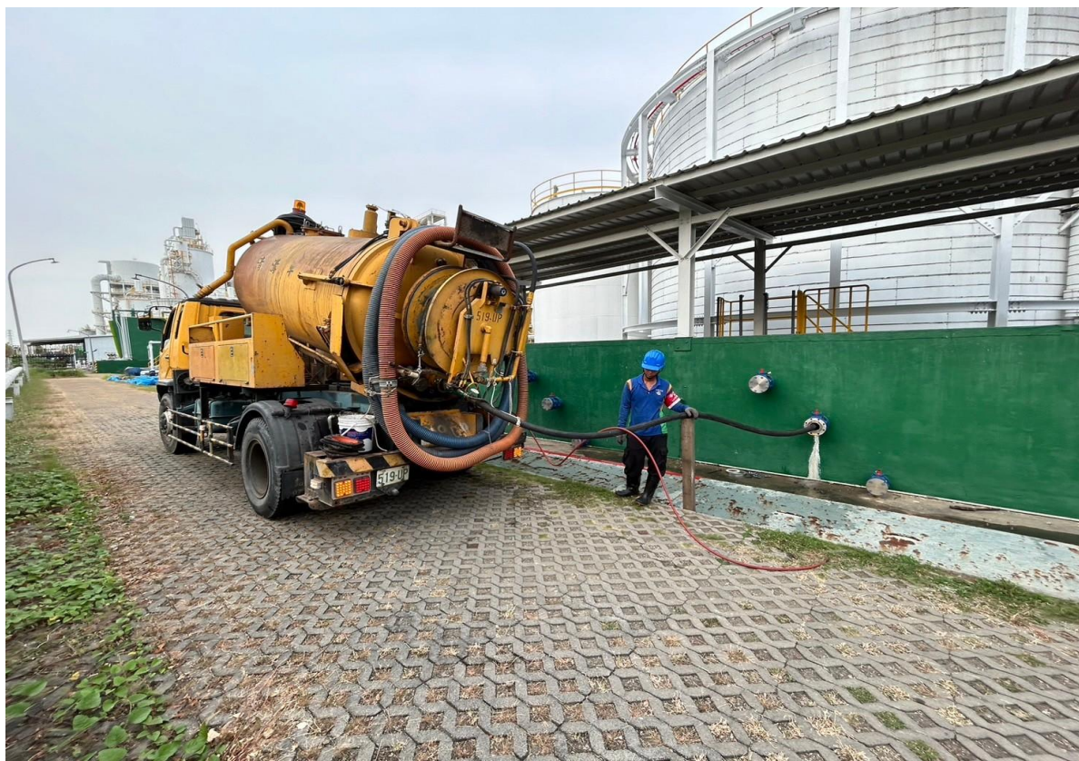
11. 槽車接收後將廢水排至指定位置
