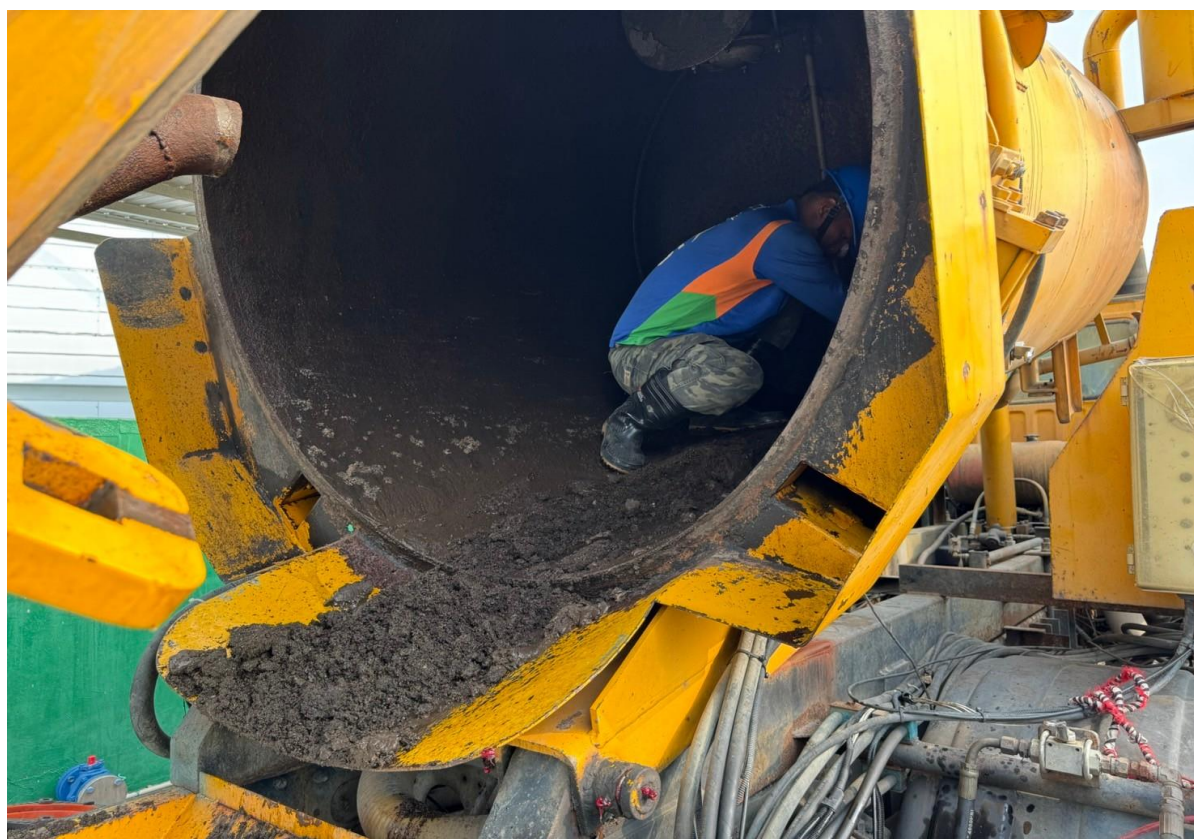
14. 槽車內部清除淤泥情形
