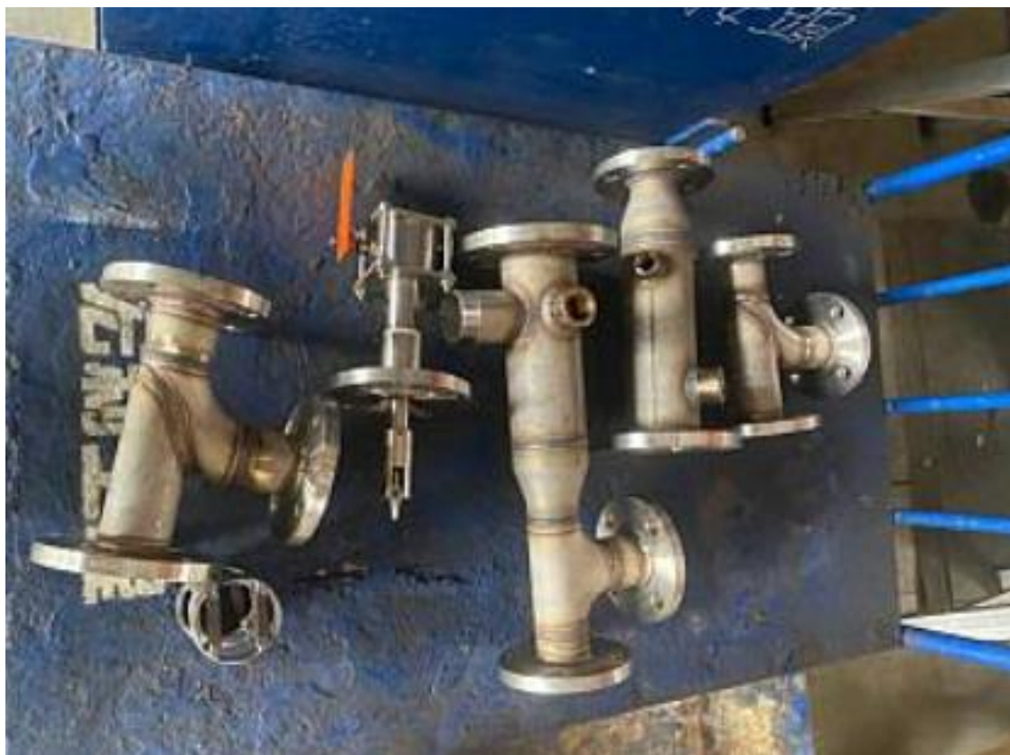
1. 管件預製完成情形(1)
