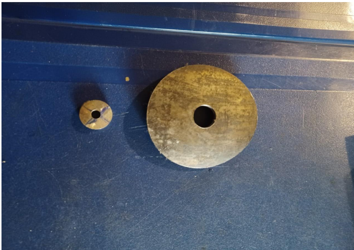
5. 管線開孔之後確認鐵片取出情形
