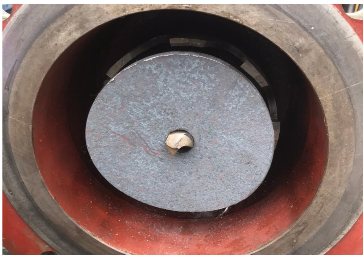
4. 人員開孔完成，確認鐵片取出
