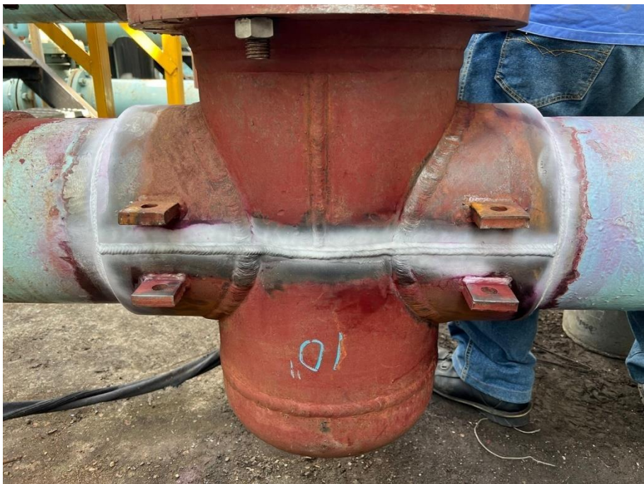
29. 模具銲道 PT 檢測(液滲試驗)
