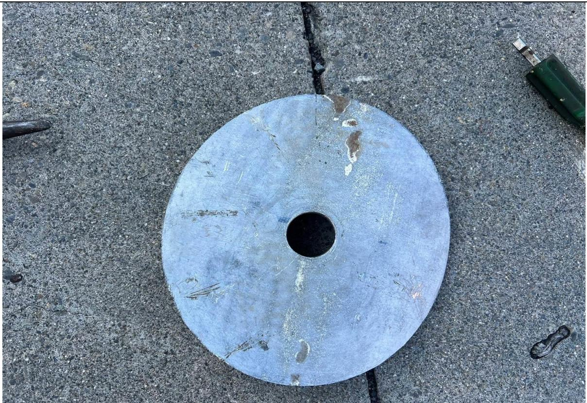
8. 管線線上開孔完成確認料塊取出(12 吋 H.T. x 1PC)
