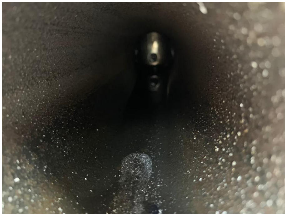
13. 切管後管內阻斷情形，阻斷率 99%
