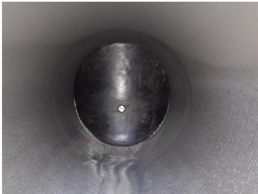
13. 切管後管內阻斷情形，阻斷率 99%
