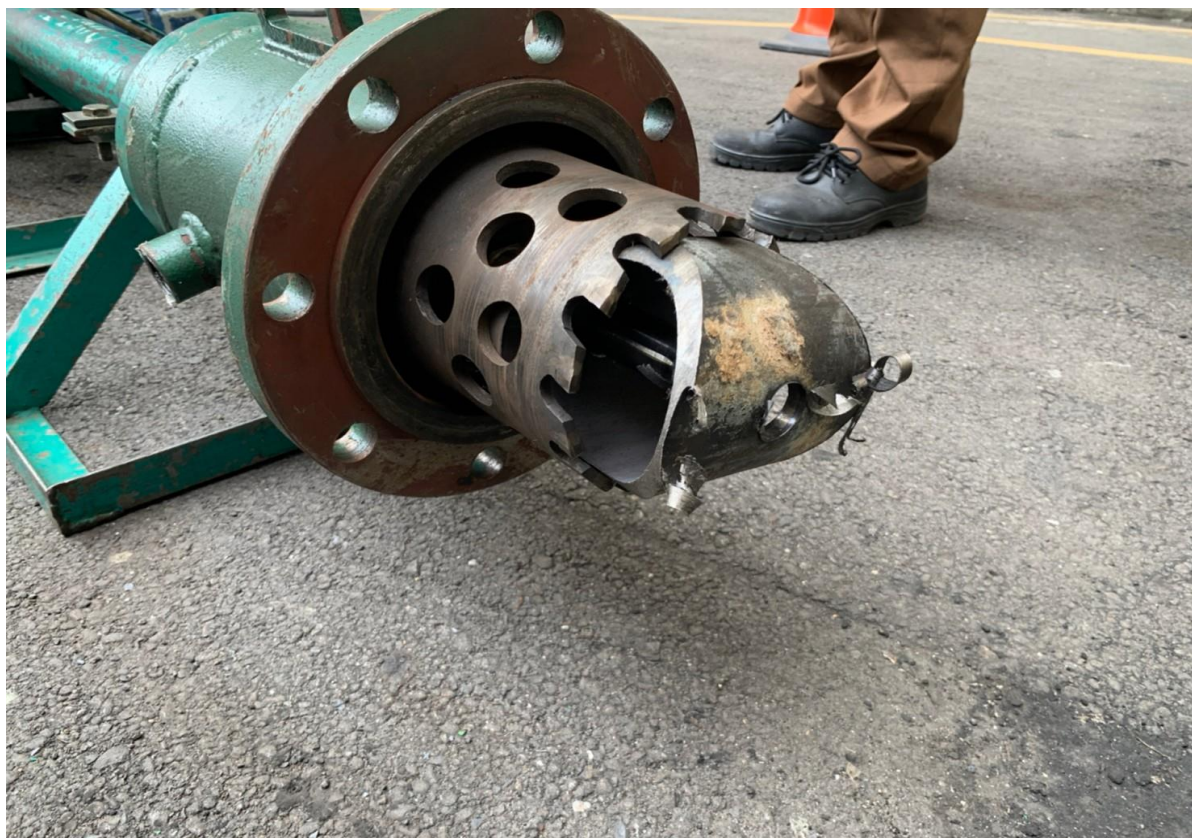
5. 斷管作業完成確認料塊取出
