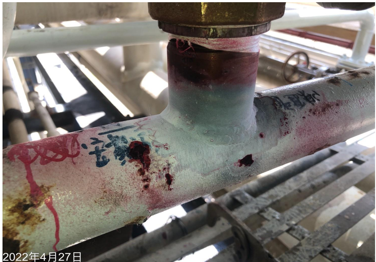
12. 模具焊道液滲檢測(PT)
