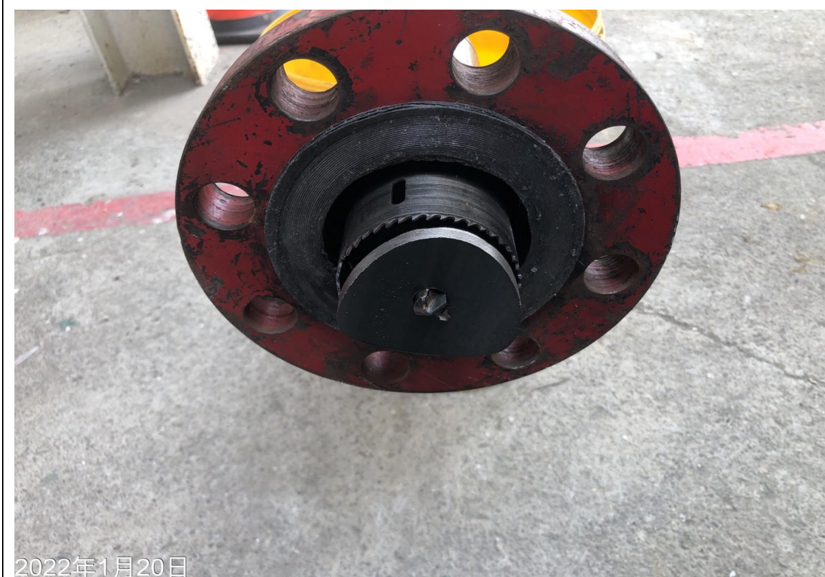
8. 開孔完成確認鐵片取出
