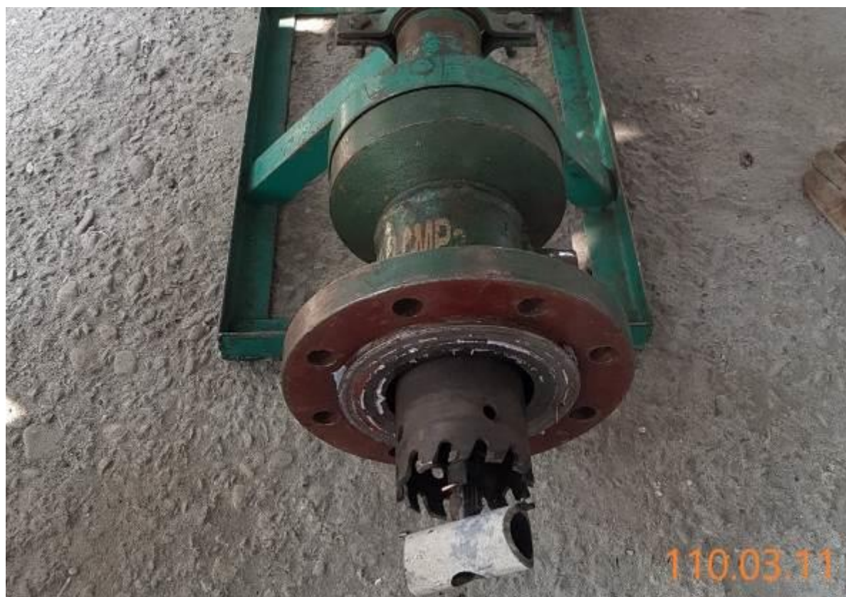
11. 斷管完成確認料塊取出
