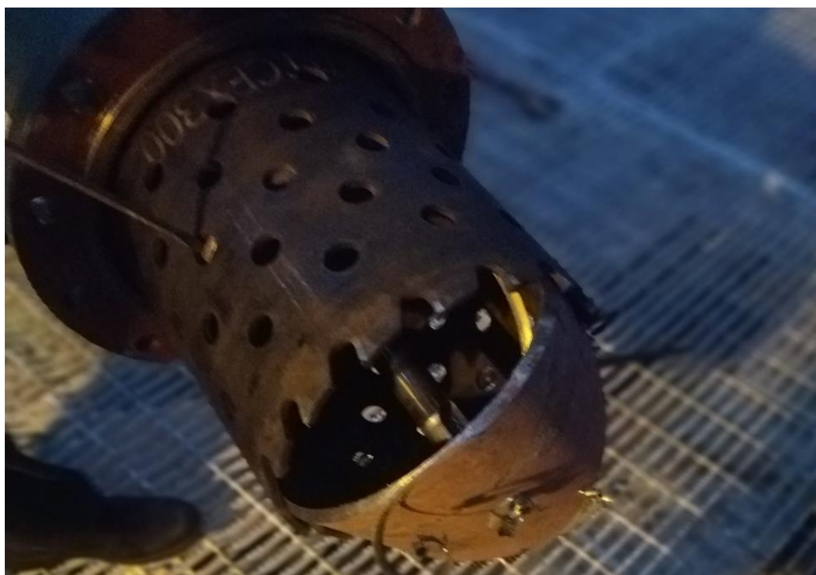
4. 斷管完成確認料塊取出
